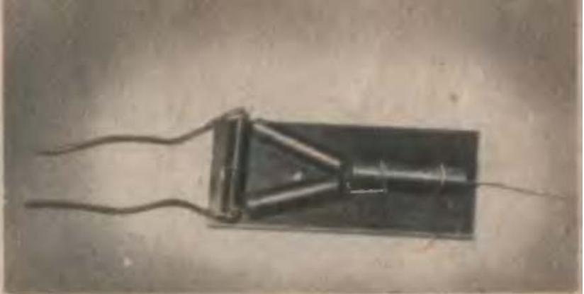
Szigetelőlapra szerelt zavarszűrő kondenzátorok
