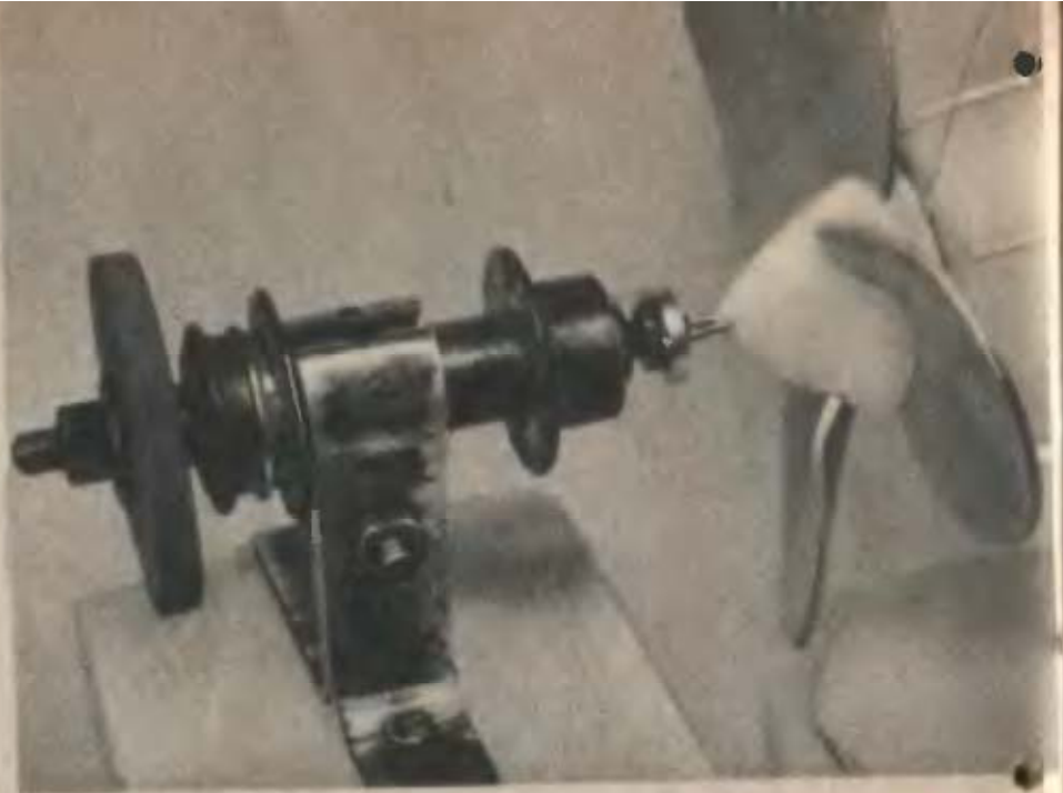
A kerékpár-elsőagyból készült orsó két csapja a ventilátor zárókupakjának két furatához csatlakozik
