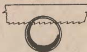
a csövet 1/3 részéig 10 mm-enként befűrészeljük
