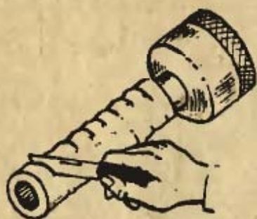
1. ábra. Késsel leszeletelünk a pumpa-tömlőből
