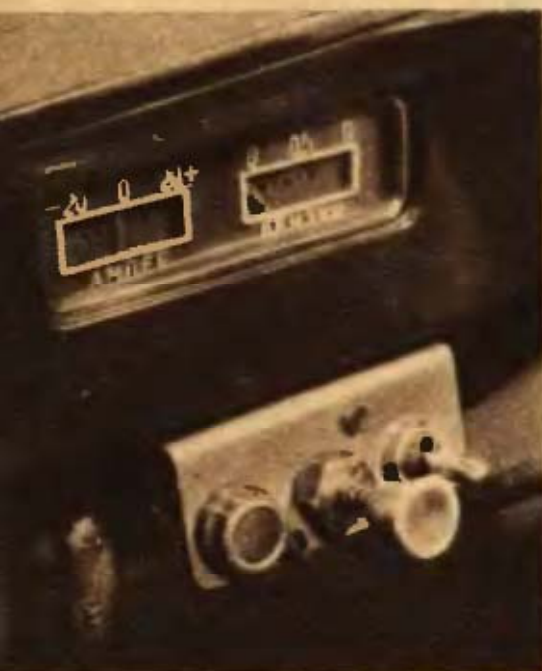
Alul: szivattyú gomb a kapcsolótábla közepén
