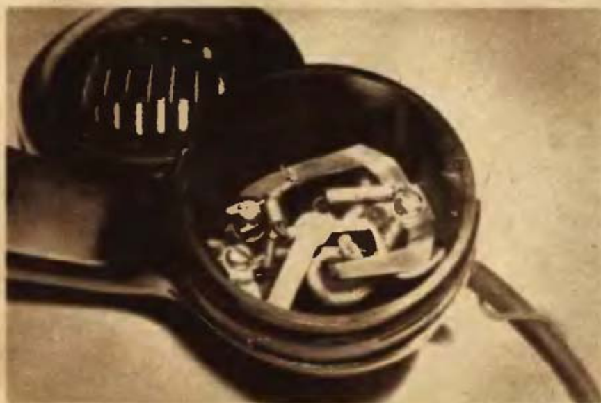
Távbeszélő összeköttetés PNP tranzisztorokkal, keresztbe kapcsolt vezetékkel.
