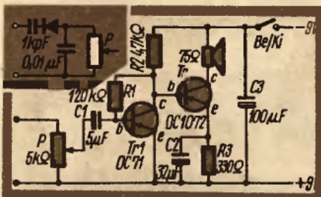
1. ábra. A kéttranzisztoros erősítő kapcsolási vázlata
