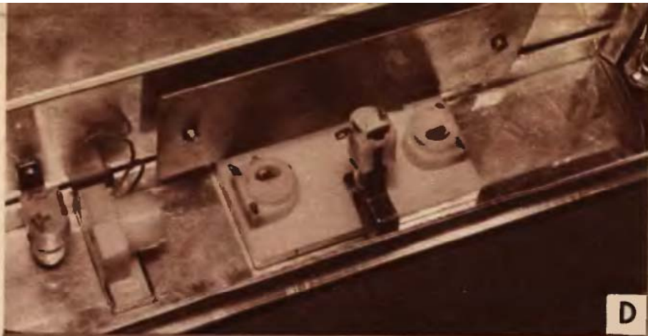
D Az álló helyzetű készülék kettős műszereit és izzófoglalatát a műszertartó lemez felső részéhez csavarozott lemezcscsik rögzíti. A kivezérlésjelző áramkör nyomtatott áramköri lemezét két M 3-as csavar tartja
