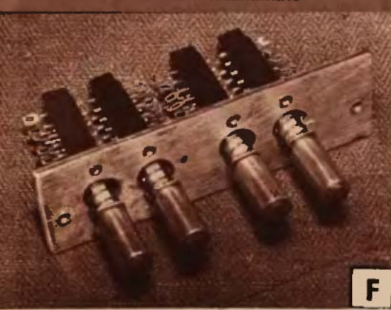
F Különálló kapcsolókból összeállított nyomógombsor. Mindkét változathoz felhasználható
