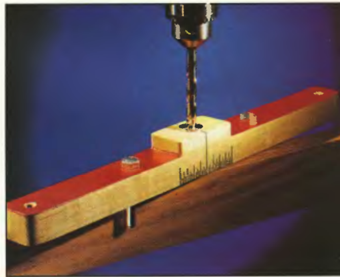
Köldökcsapozáskor a csapfészkek pontosan az anyagok élénközpontjának lesznek, ha ezt a központosítót használjuk
