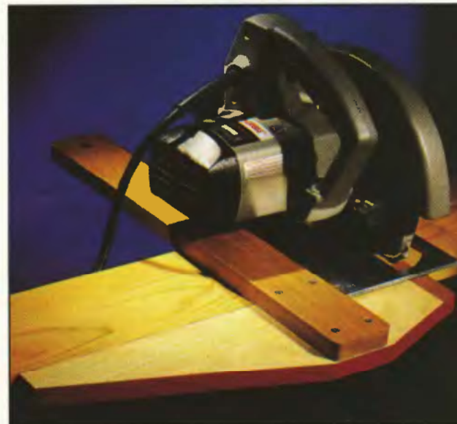
Még a keskenyebb léceket is pontosan szabhatjuk méretre e magunk készítette fűrészvezetővel
