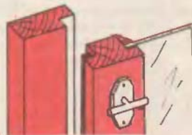
9. ábra Egyszeres ütközésű ablaknál a tömítést általában a szárnyra tesszük
