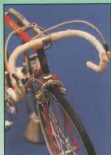
3. Az oldalhúzó fék, a bandázsolt országúti kormány és a hozzá való kormányfej még e fotón is valóságosnak hat. A homlokcsőről még a 2x3 mm-es parányi márkamatrixa sem hiányzik
