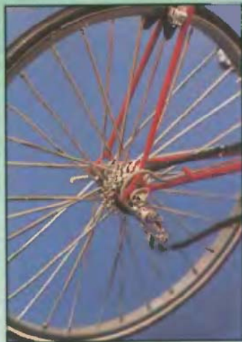
5. A hátsó váltó jól megformált, görgője, fogaskereke forog is, bár a gumilánc nem alkalmas a kerék megforgatására. Könnyen leugrik a fogaskerekekről és erősen nyúlik is, hiszen gumiból készült. E képen már elég zavaró a küllők vastagsága
