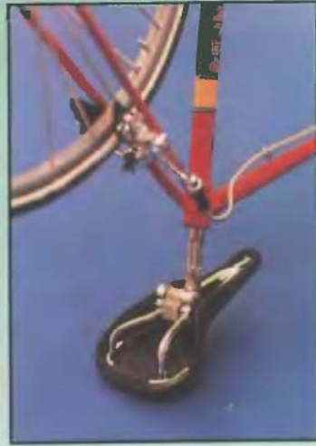
6. Íme, a Protar bicikli egyik egyenyege, amelyet a különböző nyeregretartókra bilincsekkel és egy apró csavarral kell felfogni. Még a nyeregváz feszítőcsavarja sem hiányzik róla. Igaz, nem funkcionál, csak megvan, de így teljesebb vele a kép
