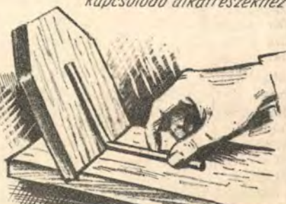
alkatrészek hajlásszögének gyors ellenőrzéséhez és másolásához
