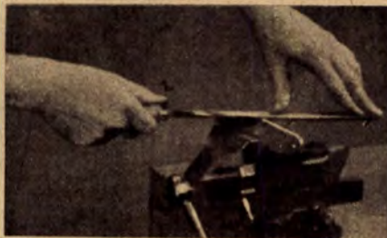
Helyes kéztartások reszeléskor
