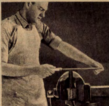
Helyesen beállított magasságú satupad reszeléskor
