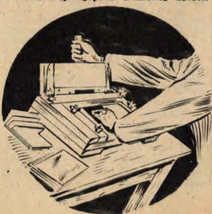
3. ábra. Hajlítógépünk működés közben
