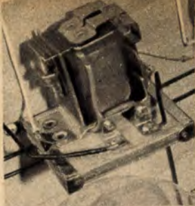
Az első relé. Az áramkört most megszakítva tartja
