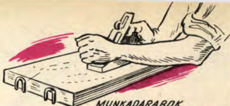
MUNKADARABOK MEGTÁMASZTÁSA A MUNKAASZ- TALBA VERT U-SZÖGEKKEL
