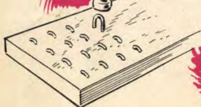
SOK U-SZÖG SÜRŰN A DESZKALAPBA VERVE CSÜKKENTI A DESZKA IGÉNYBE- VÉTELÉT, HA NEHÉZ TÁRGYAT CSÚSZTATUNK RAJTA
