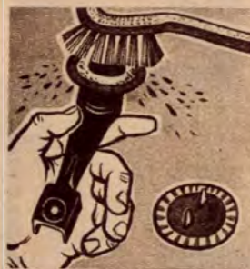
a/a ábra. Az égőrózsa erős szálú kefével, a/b ábra. A pipa üvegmosóval tisztítható
