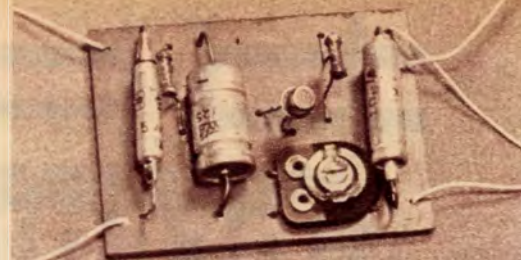
Erősítő TAA320-as integrált áramkörrel és a hozzá kapcsolódó további alkatrészekkel
