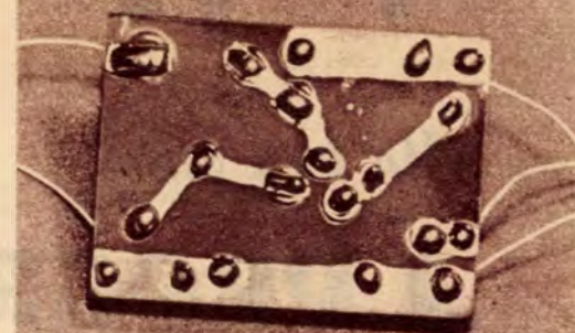
Az egyszerű erősítő nyomtatott áramköre
