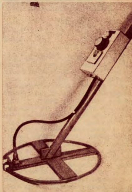
5. ábra. A „fémnyomozó” készülék üzemkész állapotban
