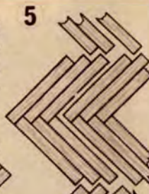
SÜLLYEDT VAKPADLÓ OKOZTA RÉSEK
