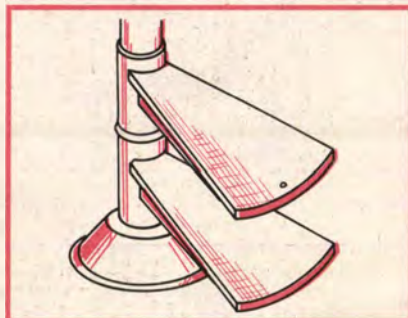
21. ábra A lépcsőfokok közé távtartó gyűrű kerül
