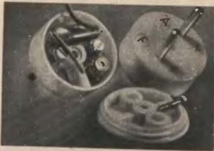
A dugóba épített készülék a fejhallgató-zsinór végződéséhez kapcsolva működik, ha az A-val és F-el jelölt villákat az antennához és a földvezetékhez csatlakoztatjuk
