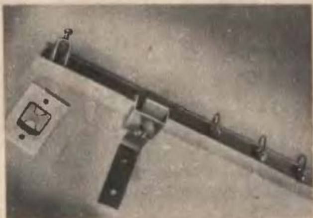
Ha nincs fakeret, ezzel a módszerrel egyszerűen a falra is felerősíthetjük a T-sínt
