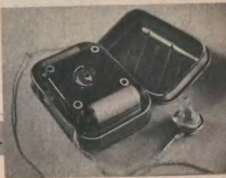
Az előtérben látható a két henger alakú, papírral szigetelt, kisméretű 3 V-os szelvélelem
