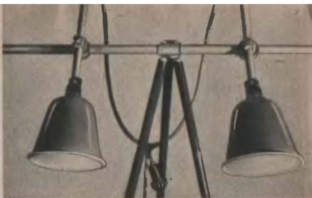
Fényképezőállványból – másolóállvány; könnyen és gyorsan állítható a megfelelő magasságban és távolságban. A kép alapján könnyű elkészíteni a tartószárakat és a sugárterelőket.
