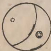
A membrán alakja és elhelyezése a levegőnyitásokon.
