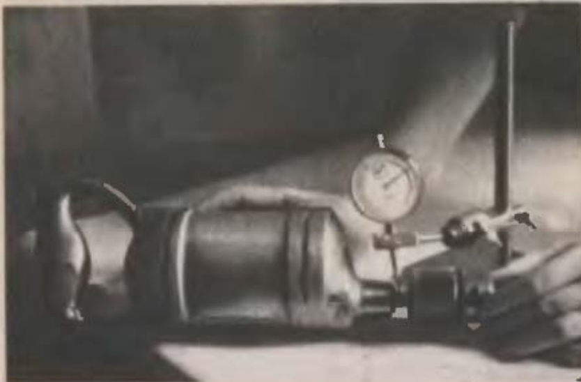
Kézfűrógép tengelyének ellenőrzése indikátor-órával
