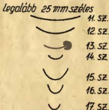
8. ábra. Különböző vésőtípusok
