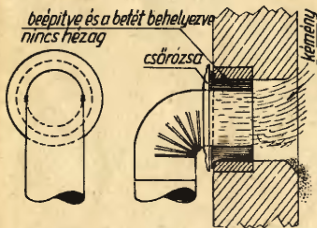
2. ábra: Betéttel ellátott füstcsőhüvely.
