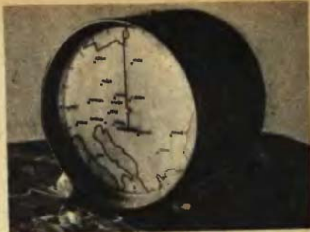
5. ábra. Térképes visszajelző műszer. Mutatója jelzi, hogy az antenna melyik adóra fordult rá.
