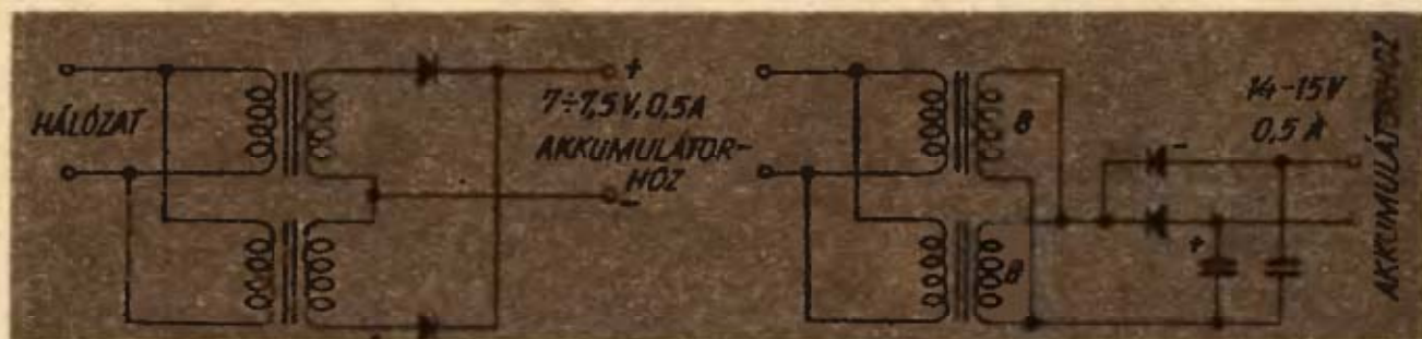
A 6\text{ V} -os ... és a 12\text{ V} -os kapcsolási rajz
