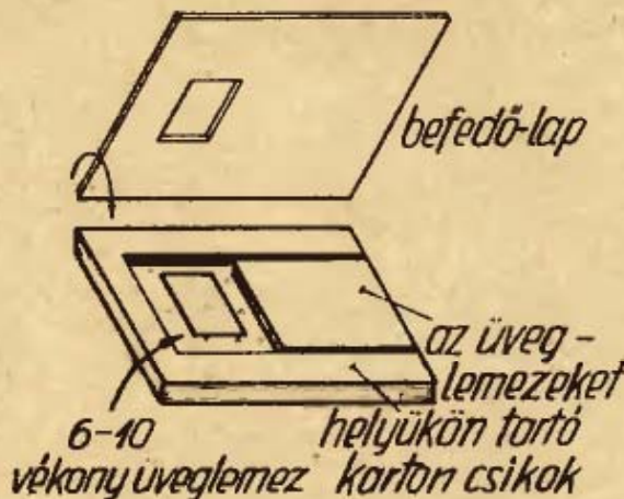
1. ábra. 6—10 mikroszkópi fedő üveglemezt teszünk egymásra és ablakkal ellátott papírlapok közé szorítjuk
