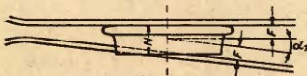
Modell vasúti kerék állása a szívdarab csúcsán NEM 310.
