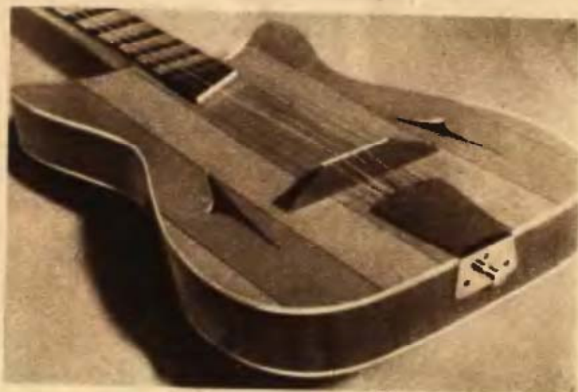
6. kép. Színes celluloid szegés, acetonban oldott cellulóddal felragasztva
