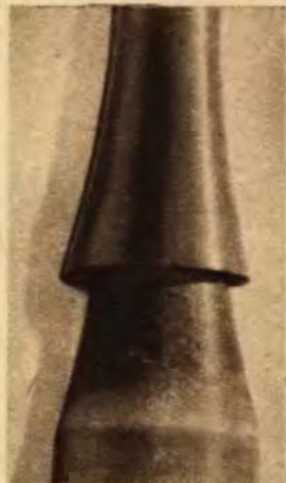
PVC csődarab alakítása formázófán
