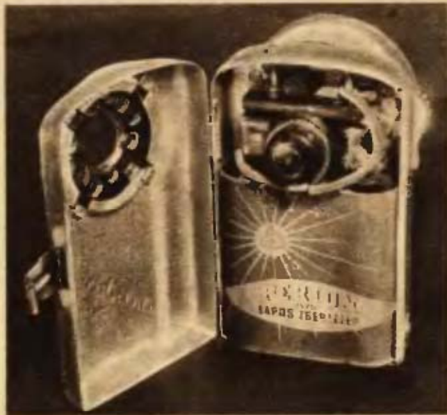
A beépített motor az érintkezőkkel. Balra láthatjuk a levegőnyílásokat
