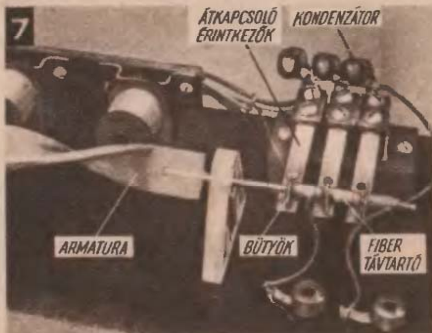
7. ábra. A bűtykök egymástól távolságát úgy alakítsuk ki, hogy azok működtethessék a megfelelő kapcsolókat. Távolságukat a rugólemez szélessége határozza meg. Biztosabb az indulás, ha az armatúra tengelye valamivel magasabban van az elektromágnesek tengelyvonalánál
