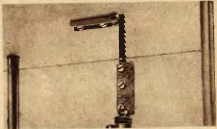
Az asztallap alsó lapjára szerelt fűrészlap-vezetőgörgő
