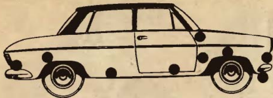
Rozsdásodás-térkép. A pontok helyén keressük a rejtett rozsdásodás-gócokat.
