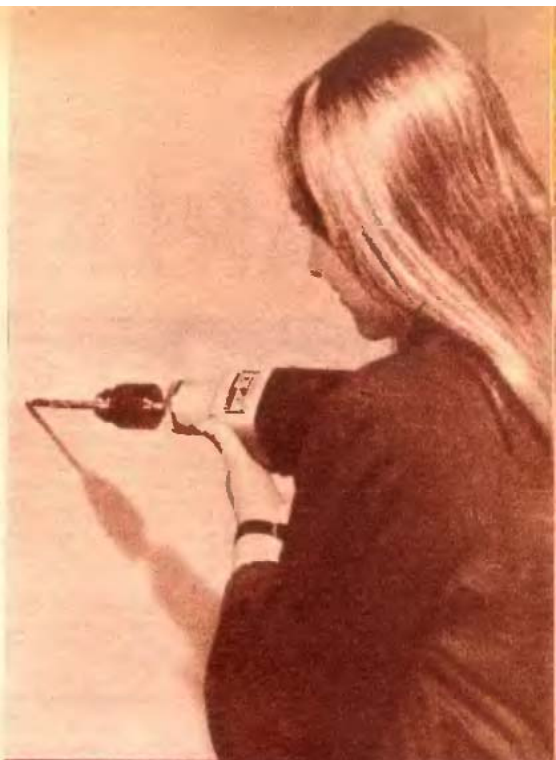
Fúrás az ÚF 1030-as ütvefúró géppel, keményfém betétes csigafúróval
