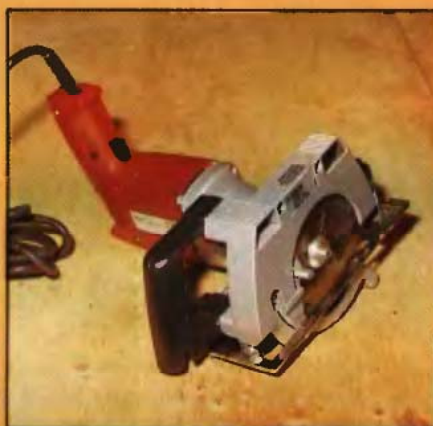
KZ-140 Körfűrész (45°-nál a vágási mélység 32 mm)
