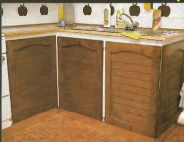
F. Az alsó szekrényekre nem célszerű üvegezett ajtókat szerelni. Az oldallapokra erősített tele ajtók még mutatósabbá teszik a bútordarabot. Az meg, ha ezt az oldalajtót ki is lehet nyitni, különösen a mély szekrényeknél előnyös.
