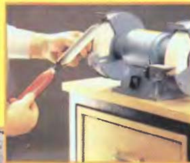
5/c ... a köszörűkoronghoz érinthessük. Ezután a kést egyenletesen forgatni kell...
