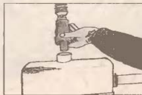
2. visszacsapó szelep behelyezés
