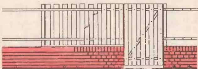
37. ábra Téglalábazatú kerítés kettős függőleges deszkázatú felső mezővel és fakapuval
