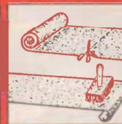
3. POLIFOAM alátéttapéta méretre vágása, bekenése a ragasztóval, rövid – max. 10 perc – pihentetése
