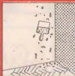
1. Alapelőkészítés: szilárd felület biztosítása
