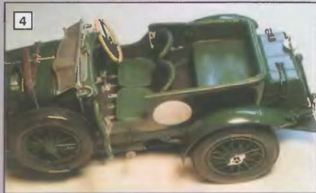
4 Valódi bőrdíszművesnek való munkát igényelt az 1/12-es veterán Btley utasterének valóságot megközelítő elkészítése. Itt minden valódi finom bőr, még az oldalkárpitok is, sőt...
