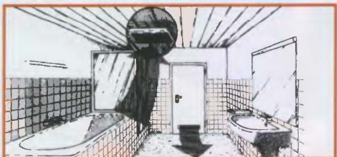
Ablakkal nem rendelkező fürdőszoba szellőztetése
